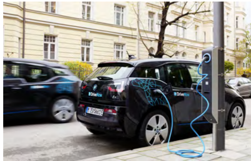
Laden an der Laterne: Mit Light & Charge werden urbane Stromquellen zur Ladestation.
