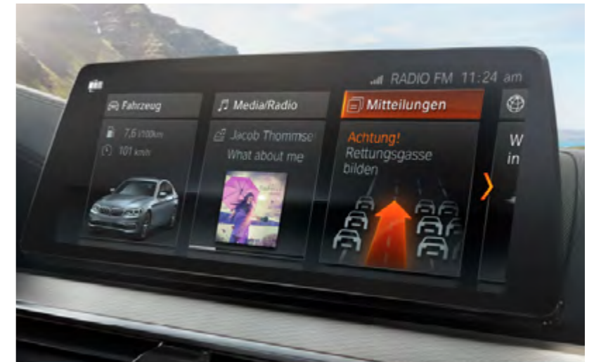
Achtung, Rettungsgasse: Auf die Displays in Fahrzeugen mit ConnectedDrive können Behörden eine Warnmitteilung für den Fahrer senden.
