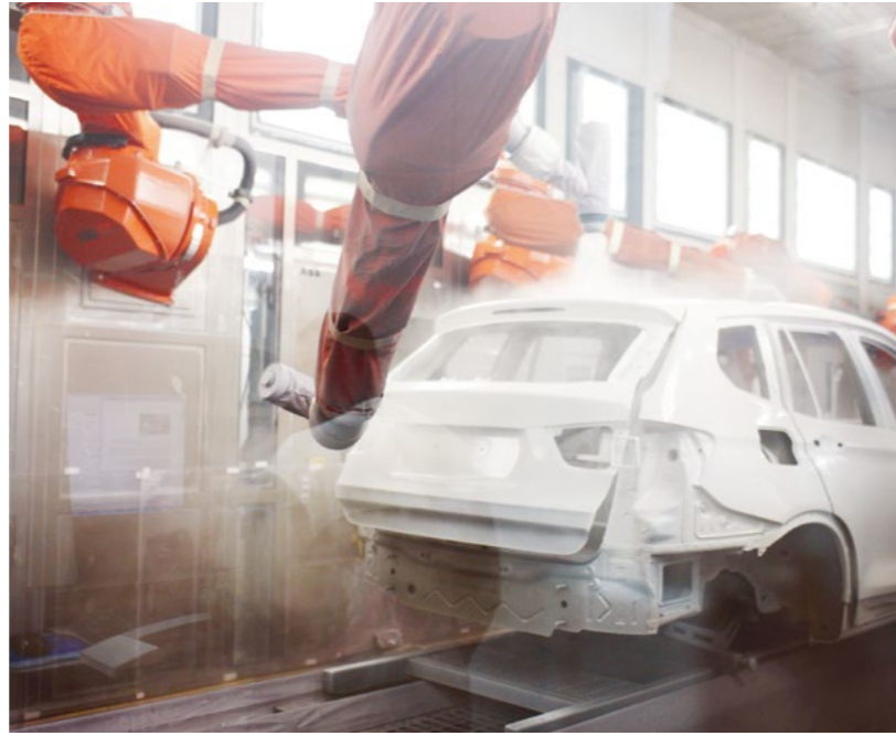
WASSERVERBRAUCH VERRINGERN — Modernes Trockenabscheidungsverfahren in der Lackiererei im BMW Werk Spartanburg.
